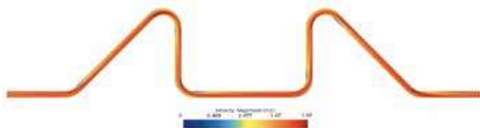
Billede 3. CFD på rørkonstruktion med et ind- og udgangsflow på 1,5 m/s. Vær opmærksom på specielt de blå markeringer, hvor flowet bliver lavt. Jo mere blå nuance, jo nærmere kommer flowet på 0 m/s, dvs. næsten stillestående væske. De mørkerøde markeringer har et højere flow.
